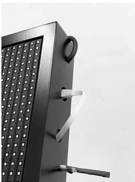
Rys. 2.2 – wyprowadzenie przewodu LAN
