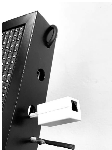
Rys. 2.1 – wyprowadzenie przewodu LAN
